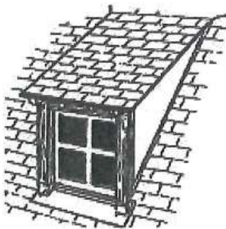
lucarne rampante ou en chien couché
